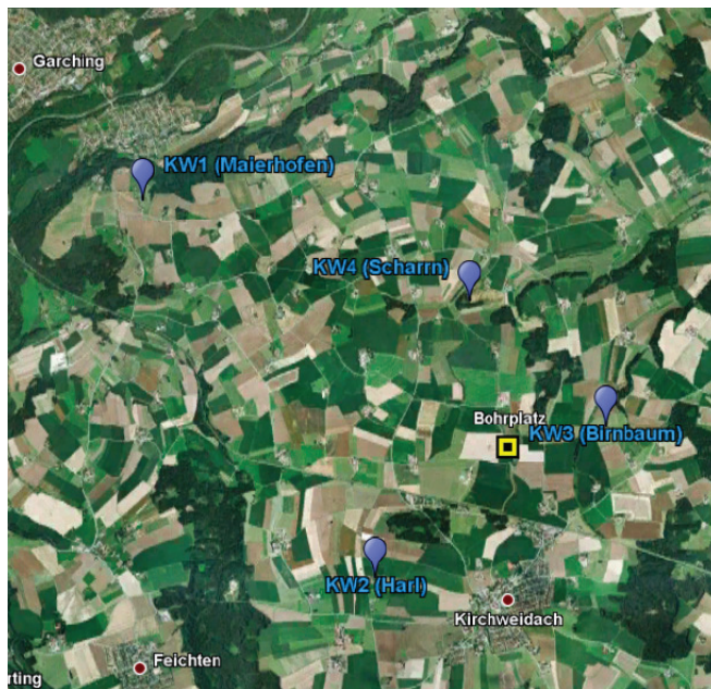
Abb. 1: Geometrie des seismischen Netzwerks um die Bohrung Kirchweidach. KW1-3 sind permanent installierte Stationen mit Echtzeit-Kommunikation, KW4 wird derzeit nur temporär besetzt und die Daten vor Ort auf Datenträger gespeichert.
